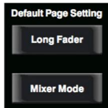
Seleccione la pantalla que desea ver al encender el mezclador: Long Fader o Mixer Mode.
