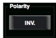
Utilice este ícono para invertir la fase de la señal del canal (a 180~). Cuando la función esté activada, la tecla se iluminará y la visualizará en la pantalla en tiempo real. Podrá utilizar este control de polaridad para corregir señales de audio fuera de fase y también para cancelar o reforzar fases.
