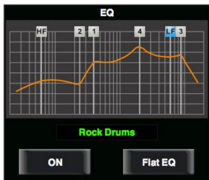
Active la función ecualizador con el ícono ON. Al oprimirlo la tecla se iluminará y sincronizará con el control de la pantalla EQ. Utilice la pantalla EQ para configurar los valores de ecualizador. En esta instancia solo podrá cargar los parámetros ya establecidos y visualizarlos en la cuadrícula.
