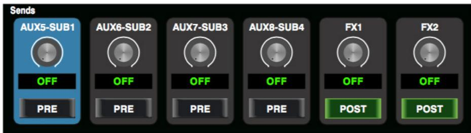
En la pantalla LCD, presione los íconos AUX 5-8 (SUB 1-4) y FX 1-2 para asignar el canal de audio de entrada a estos canales o buses. Utilice la perilla de ajuste para regular el nivel de salida del canal de audio.
