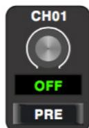
Presione el ícono para enviar el canal de entrada 1 a AUX 1 (por ejemplo). Utilice la perilla de ajuste o el fader largo para cambiar el nivel de audio del canal seleccionado.
